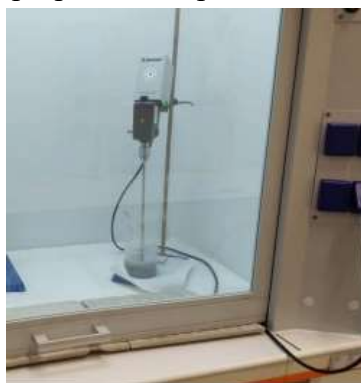
Obr.2.: Príprava elektroizolačnej vrstvy \text{SiO}_2 .
