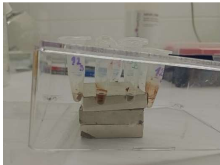
Obr. 1 Agregácia MNP po aplikácii vonkajšieho magnetického poľa.
